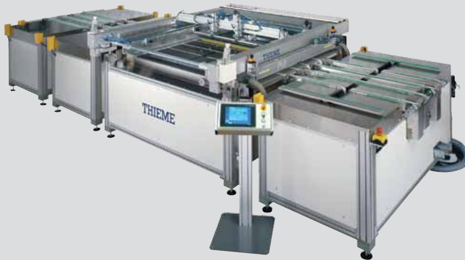
Abb. 1: THIEME 3000 GS zur Bedruckung von Glas und anderen starren Materialien Pic. 1: THIEME 3000 GS prints on glass and other rigid substrates
